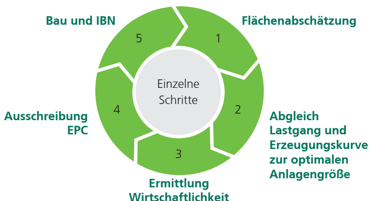
Abbildung 2: Vorgehensweise bei der Realisierung einer Eigenverbrauchsanlage
